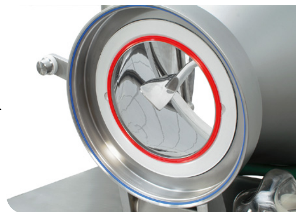
Optimierte Dichtungen im Bereich der Zubringung
